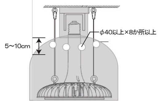
※セードを残して設置する場合は、セードの上部(5~10cm位を目安)にφ40以上の通気用の穴を8か所以上開けて使用してください。
